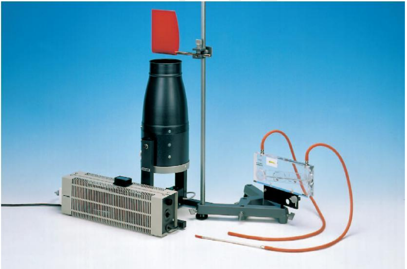
Рис. 1а: Экспериментальная установка для определения распределения напора по крылу.
