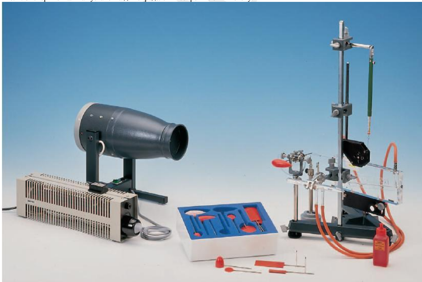
Рис. 1: Экспериментальная установка для определения сопротивления потоку.
