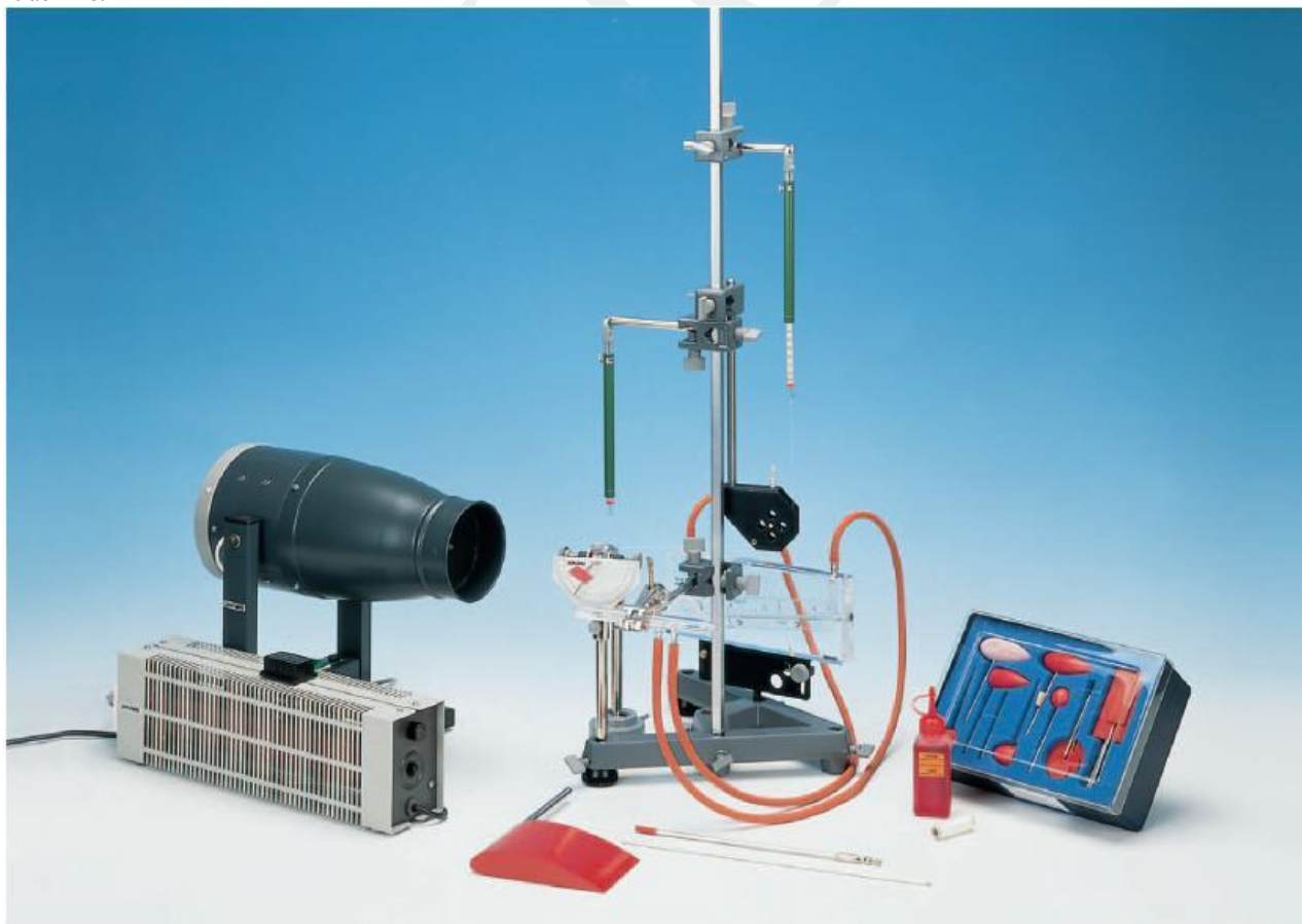
Рис. 16: Экспериментальная установка для определения подъемной силы и гидродинамического сопротивления на прямоугольной пластине.
