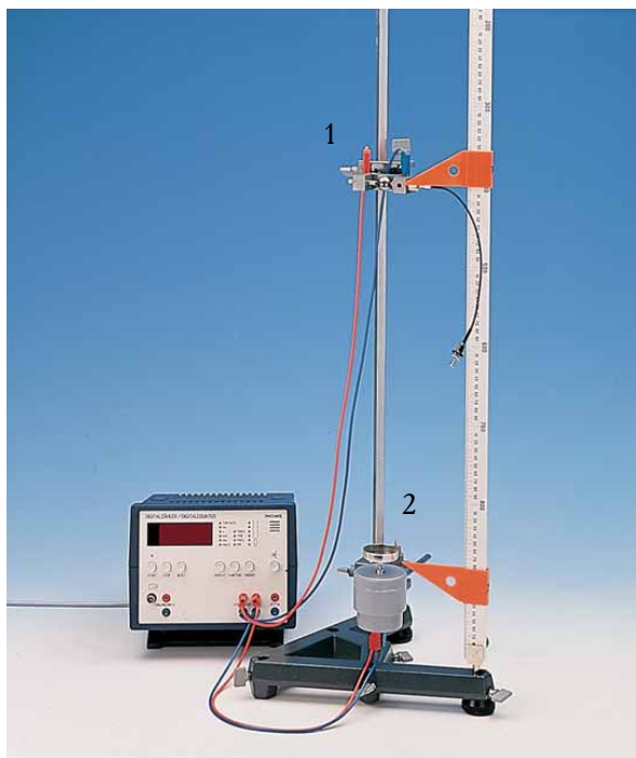
Рис. 1. Установка для исследования свободного падения
