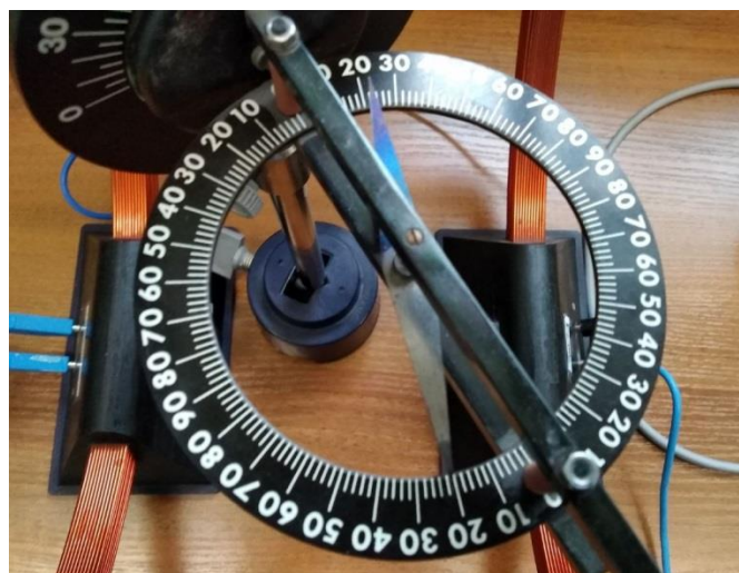
Рис.7 Горизонтальное положение шкалы магнитометра. Стрелка показывает направление магнитного меридиана.
