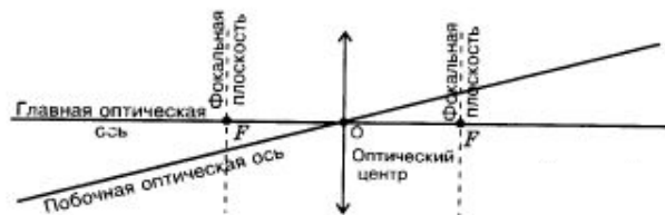
Рис. 1 Главные точки, оси и плоскости линзы
