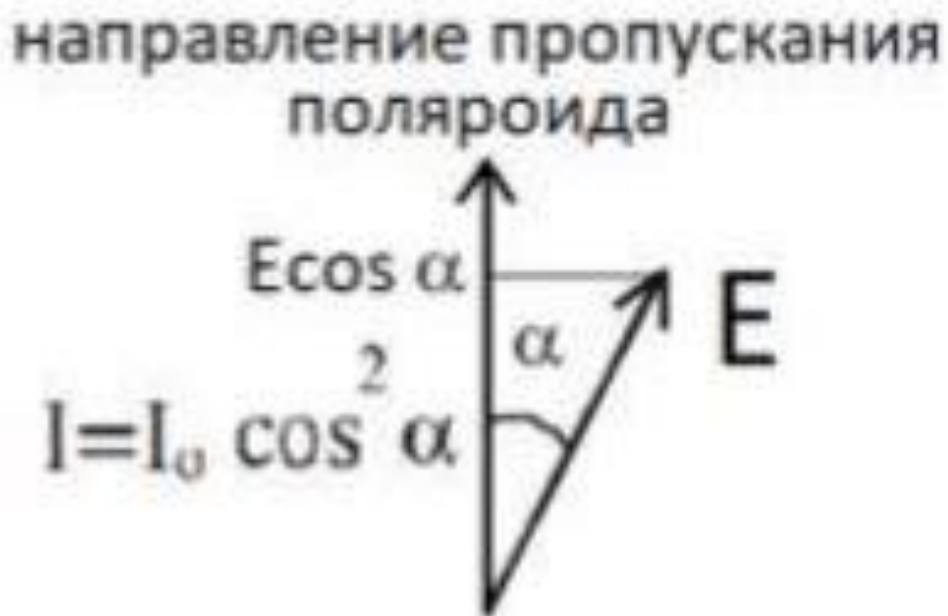
Рис. 2.3. Направление пропускания поляроида.
