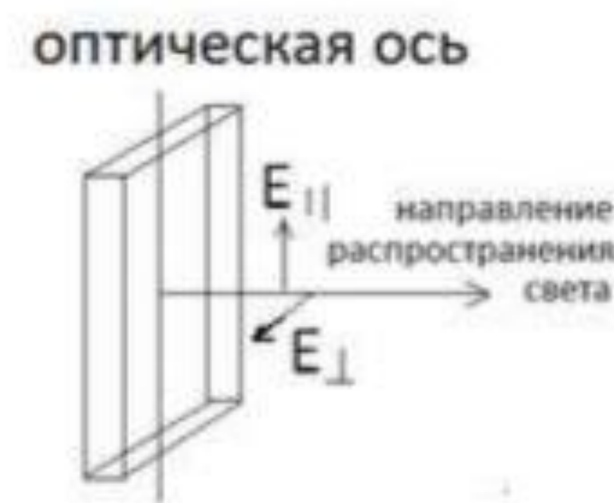
Рис. 2.4. Направление распространения света в фазовых пластинках.
