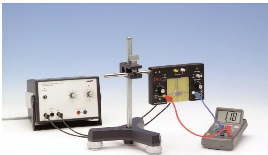
Рис. 2. Экспериментальная установка для определения ширины запрещённой зоны германия.
