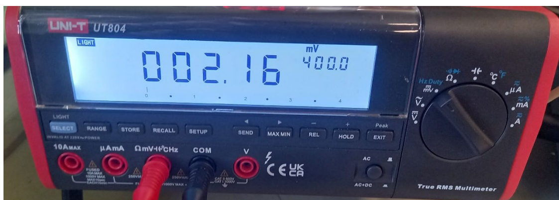
Рисунок 3 – Мультиметр UT804 в режиме милливольтметра
