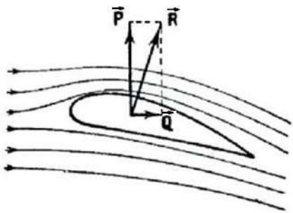
Он же вывел формулу для определения величины подъемной силы. Подъемная сила единицы длины крыла бесконечного размаха равна произведению циркуляции скорости вокруг профиля крыла на плотность среды и скорость набегающего потока:
