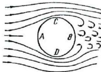
Таким образом, лобовое сопротивление складывается из сопротивления трения и сопротивления давления. При данных поперечных размерах тела сопротивление давления сильно зависит от формы тела. По этой причине его называют также сопротивлением формы. Наименьшим сопротивлением давления обладают тела хорошо обтекаемой каплевидной формы. Такую форму стремятся придать фюзеляжу и крыльям самолетов; кузову автомобилей и т. п.
