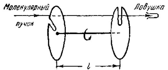
определенным значением скорости. Меняя скорость вращения прибора, можно выделять из пучка атомы, обладающие различными скоростями. Число этих атомов для каждого интервала скоростей определяется по времени, которое требуется для того, чтобы на пластинке появился осадок, видимый в микроскоп. Результаты опытов Ламмерта и других опытов, проводившихся с той же целью, подтвердили справедливость распределения по скоростям, теоретически установленного Максвеллом.
