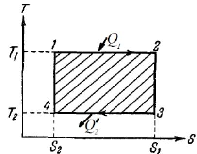
В 1824 г. французский инженер Сади Карно проанализировал обратимый цикл, состоящий из двух изотерм и двух адиабат, и показал, что такой процесс имеет максимальный КПД из всех процессов, происходящих при тех же температурах нагревателя и холодильника. Такой цикл называется циклом Карно.
