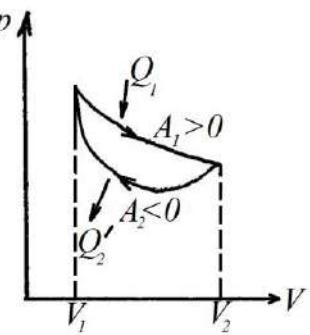
При любом циклическом процессе необходимо отдать  $Q_2' > 0$ . Введем коэффициент полезного действия (КПД) тепловой машины:  $\eta = \frac{Q_1 - Q_2'}{Q_1} < 1$ .
