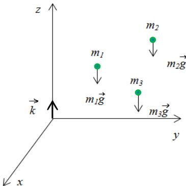
$$\frac{d\vec{p}_{\text{сист}}}{dt} = \vec{F}_{\text{внеш}}$$
