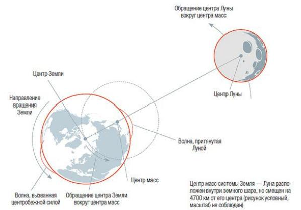
**уравнение движения центра масс системы.** Из него следует, что *центр масс системы движется как материальная точка, масса которой равна сумме масс всей системы, а действующая сила – векторной сумме всех внешних сил, действующих на систему.*
