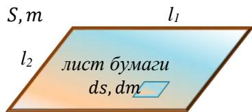
$$\sigma = \frac{dm}{dS} \quad \text{поверхностная плотность} \quad (\sigma = \frac{m}{S} \quad \text{для однородного тела})$$
